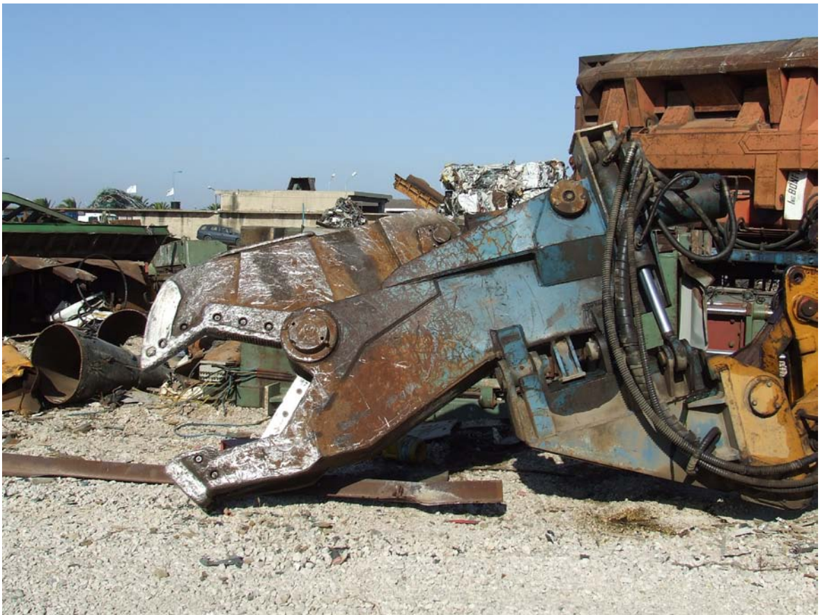
POCLAIN CKB 220, 1989, PESO 45000 KG C/ TESOURA DUDLEY CLEAVER 550 C/ ABERTURA DE 780 MM
